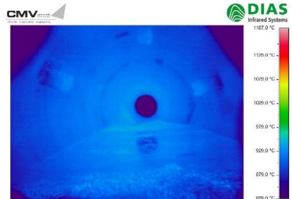
Infrarotbild: Gute Durchsicht durch den Ofen trotz hohem Staubanteil.
